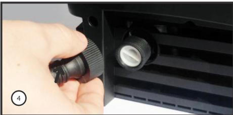
4. Conecte o espigão do engate rápido (exclusivo para o equipamento WAP), na conexão de entrada de água do equipamento.
