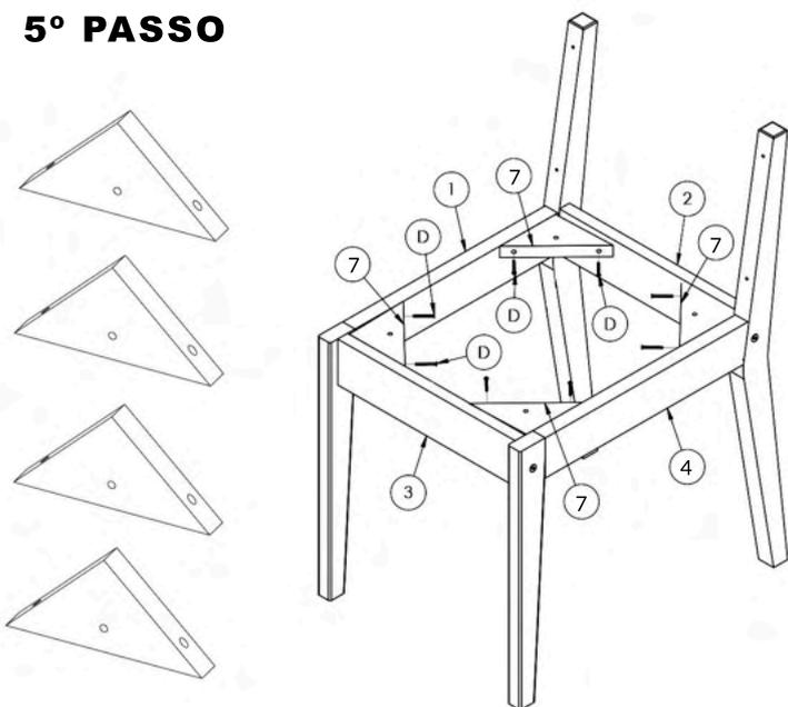
FIXAR OS 4 SUPORTES EM FORMA DE TRIANGULO. Fixar os suportes (7) nas peças (1), (2), (3) e (4) com os parafusos (D) utilizando uma Chave Phillips.
