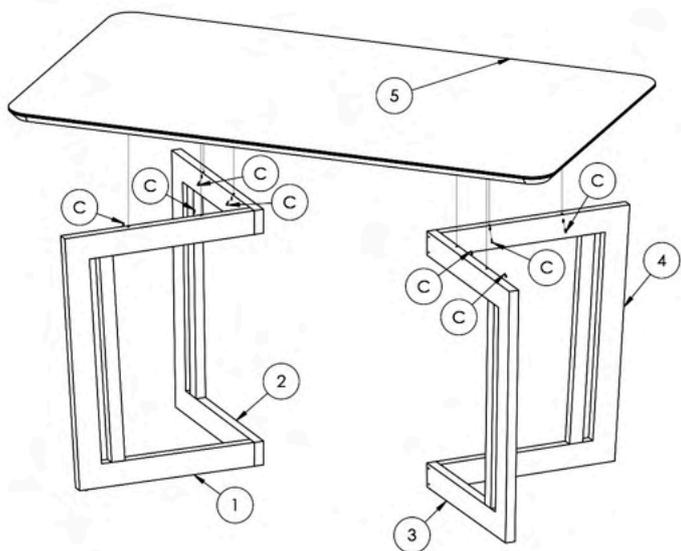
Fixar o Tampo (5) utilizando os Parafusos (C) com uma Chave Phillips
