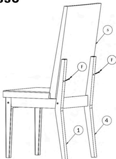
Fixar o Encosto (5) nas peças (1) e (4) utilizando os Parafusos (F) com uma Chave Phillips. Tampar os Furos com a Bucha Tampa Parafuso.
