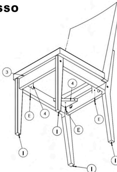
Fixar os Parafusos (E) de baixo para cima nos Suportes (4) em forma de Triangulo utilizando uma Chave Phillips, Tampar os furos com Tampa Furos (G), fixar as Sapátas (I).
