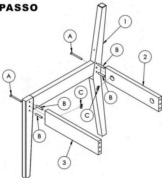
Passar Cola (G) nos furos das Cavilhas da peça (1), fixar as Cavilhas (B) na peça (1), fixar as peças (2) e (3) na peça (1), fixar as Porca meia Lua (C) nas peças (2) e (3), fixar os Parafusos (A) com a Chave Zeta (H) na peça (1).
