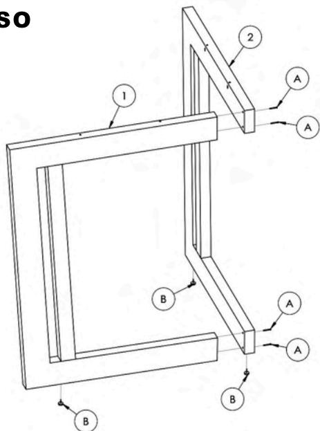
Fixar a peça (1) na peça (2) utilizando os Parafusos (A) com uma Chave Phillips.
