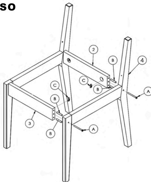
Passar a cola (G) nos furos das Cavilhas na peça (4), fixar as Cavilhas (B) na peça (4), fixar a peça (4) nas peças (2) e (3), fixar as Porca meia Lua (C) nas peças (2) e (3), fixar os Parafusos (A) com a Chave Zeta (H) na peça (4).
