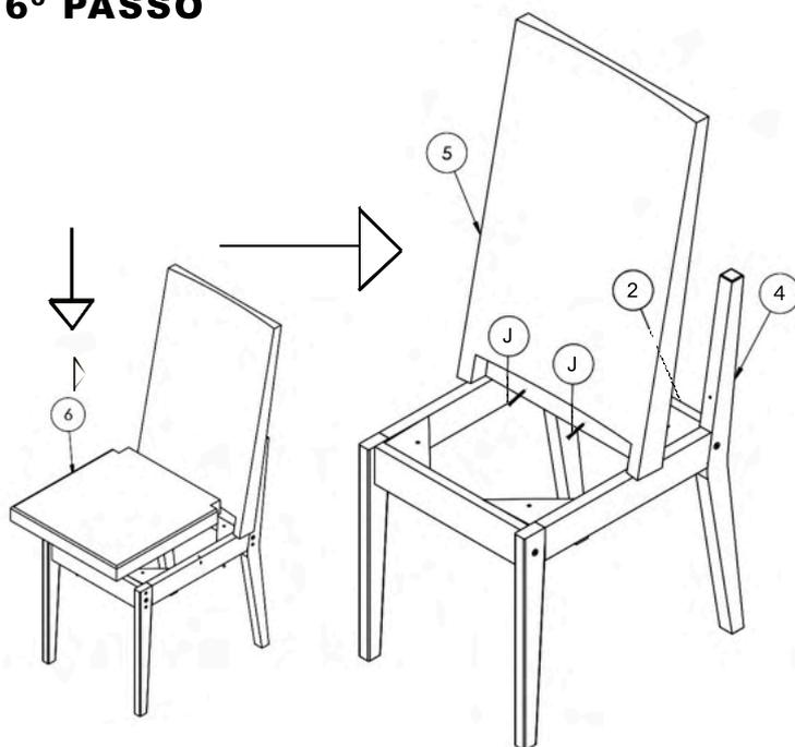
Encoste o Encosto (5) nas peças (4) e (1). Fixe os Parafusos (J) na peça (2). Encaixe o Assento (6) no Encosto (5).
