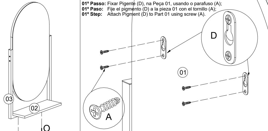
**01º Passo:** Fixar Pigante (D), na Peça 01, usando o parafuso (A);
