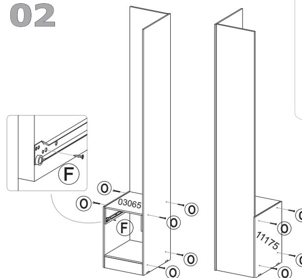
Para fixar um módulo ao outro, use uma broca de 6 mm para atravessar os pré furos do lado desejado. Em seguida utilize os parafusos de União (N).
