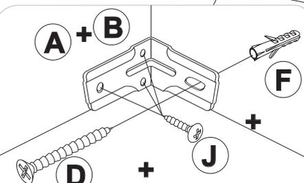
Para a fixação do Armário, instalar o apoio aéreo com os acessórios (D)+(J)+(F).
