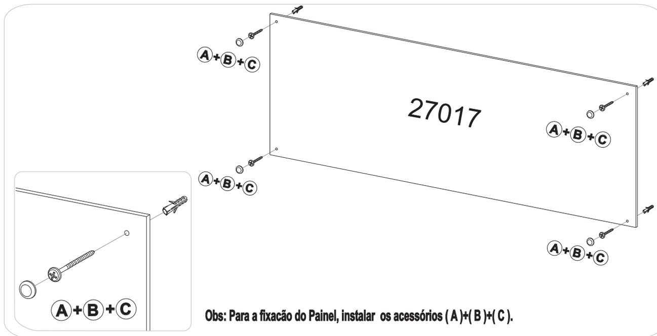
Obs: Para a fixação do Painel, instalar os acessórios (A)+(B)+(C).
