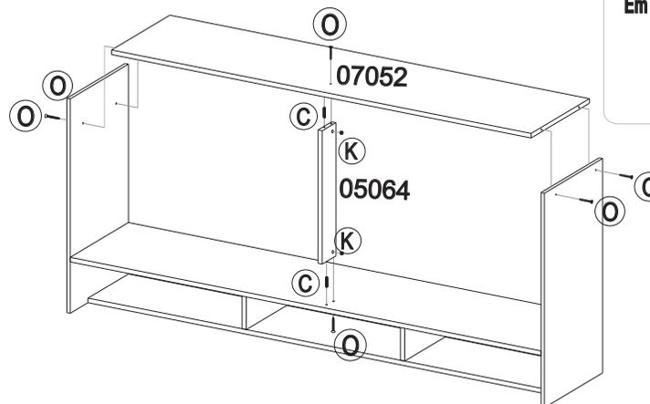
Para fixar um módulo ao outro, use uma broca de 6 mm para atravessar os pré furos do lado desejado. Em seguida utilize os parafusos de União (N).
