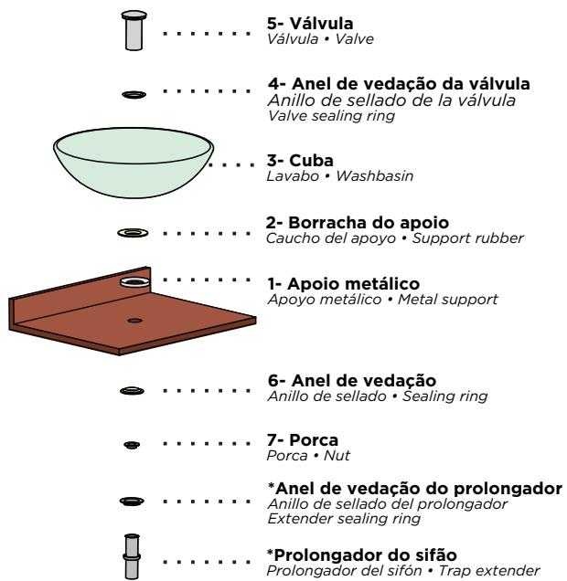
Para instalação adequada da cuba de vidro, siga a sequência numérica na figura ao lado, instalando os componentes na ordem indicada.
